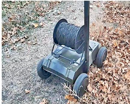
**Радиоуправляемая платформа для прокладки проводной связи на передовой**
