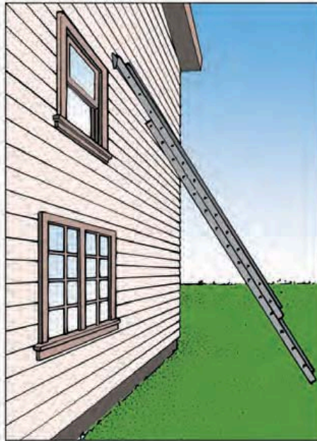
Trop loin du bas mur.
