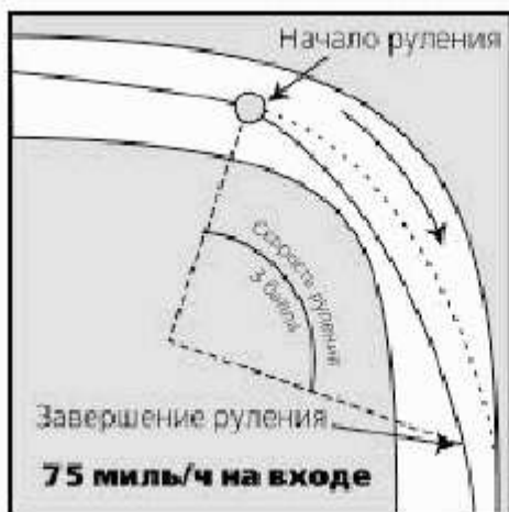
Рисунок 2. При медленном рулении траектория распрямляется.
