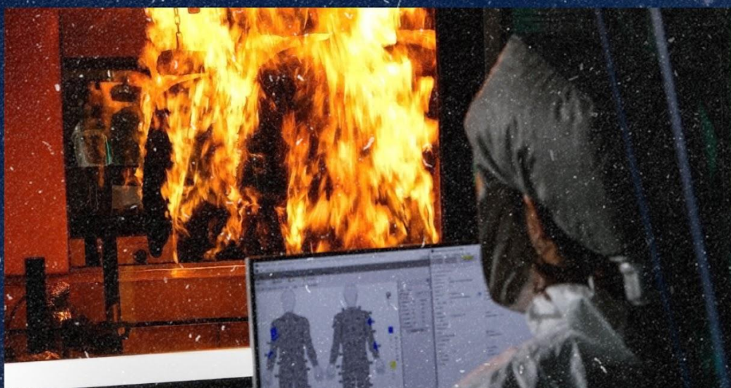
Испытания материалов на тепловых манекенах с использованием современных технологий.
