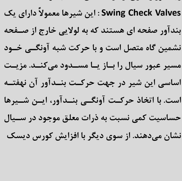
میتواند سرعت واکنش شیر را تحت تأثیر قرار داده و یا در موارد حاد، حتی باعث عمل نکردن شیر شود. البته در بعضی از طراحی ها، از بندآور توپی شکل استفاده شده که نیاز به استفاده از راهنمای مرتفع می کند، اما مشکل ویسکوزیته سیال، همچنان به جای خود باقی است. به همین دلیل این شیرها برای سیالات غیر ویسکوز و عاری از ذرات معلق مناسب تر هستند.
