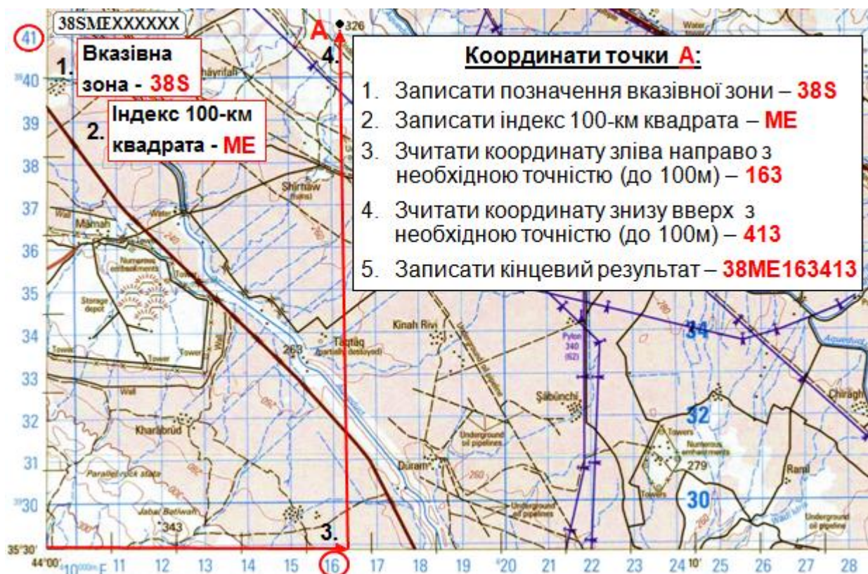
Рисунок 6.15 – Порядок цілеуказання за кілометровою сіткою UTM на топографічній карті НАТО масштабу 1:100 000
