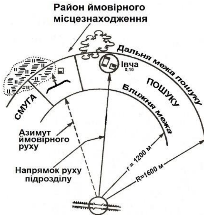
Рисунок 3.15 – Відновлення орієнтування графічним способом
