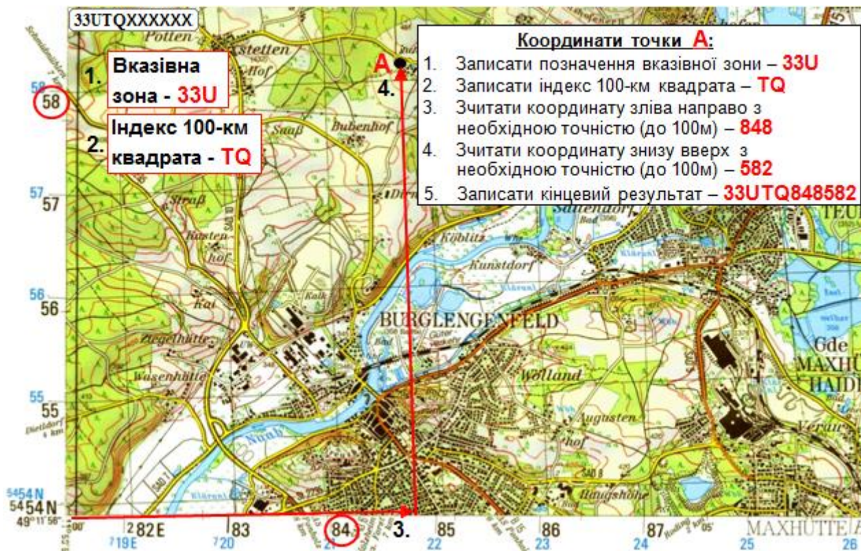
Рисунок 6.16 – Порядок цілеуказання за кілометровою сіткою UTM на топографічній карті НАТО масштабу 1:50 000
