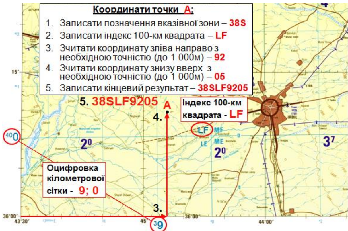
Рисунок 6.14 – Порядок цілеуказання за кілометровою сіткою UTM на топографічній карті НАТО масштабу 1:250 000
