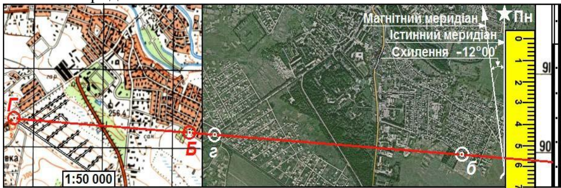
Рисунок 4.4 – Нанесення істинного і магнітного меридіанів на аерознімок
