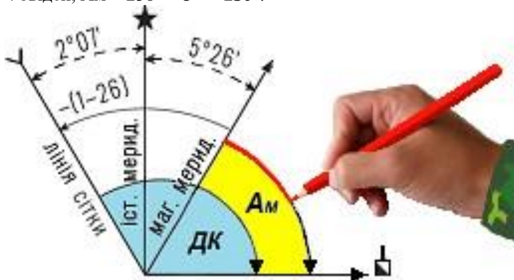
Рисунок 1.31 – Графічний спосіб визначення поправки напрямку
