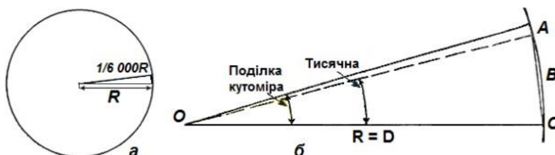
Рисунок 2.8 – Поділ кутоміра і тисячна
