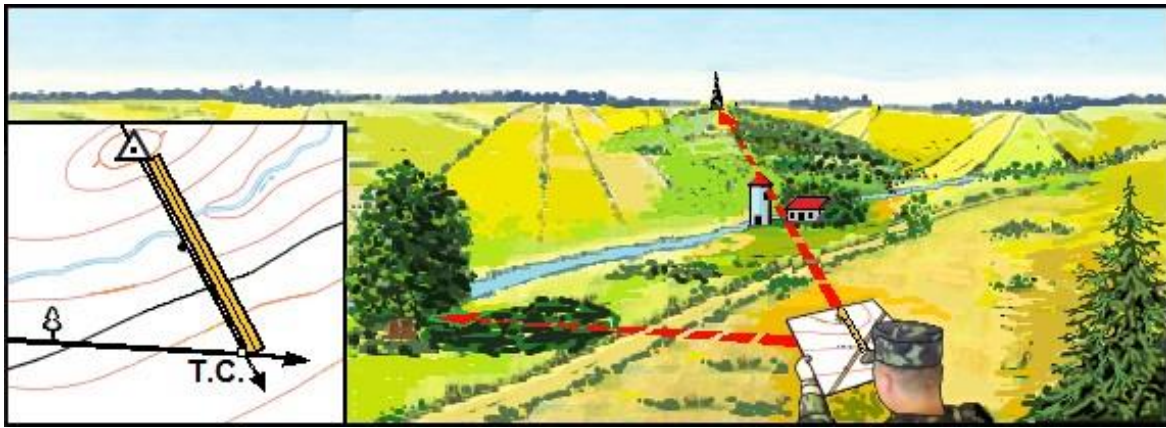
Рисунок 3.7 – Визначення точки стояння за створом і боковим орієнтиром
