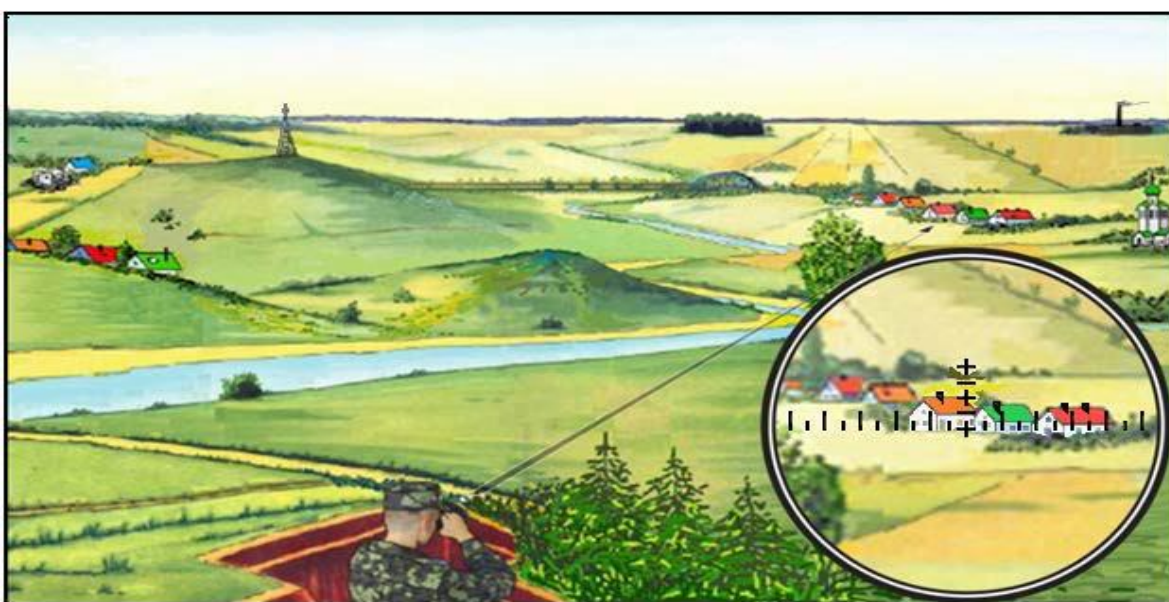
Рисунок 2.10 – Визначення відстані за шкалою бінокля
