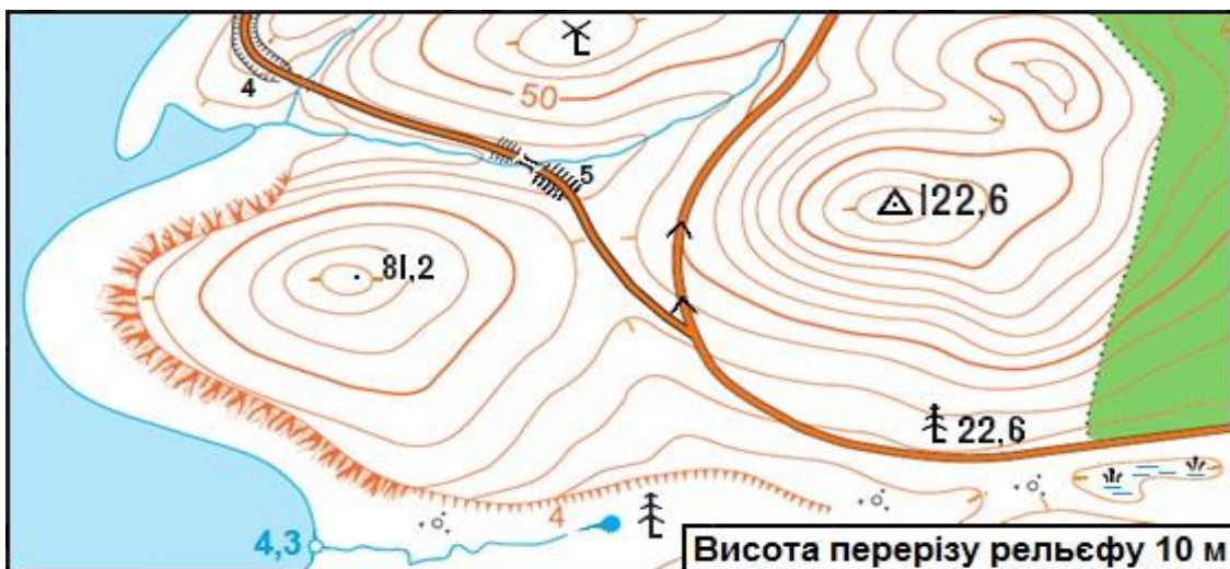
Рисунок 1.11 – Визначення ознак зниження схилу на карті
