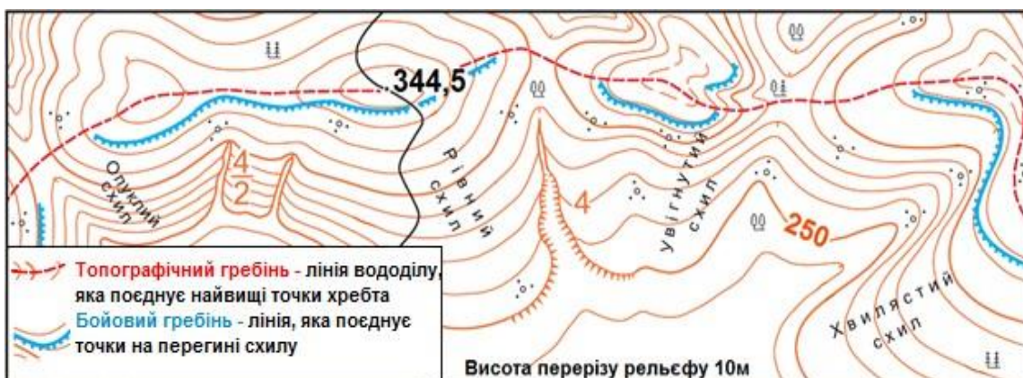
Рисунок 1.15 – Визначення різновидів схилу, топографічного і бойового гребенів за зображенням горизонталей на карті
