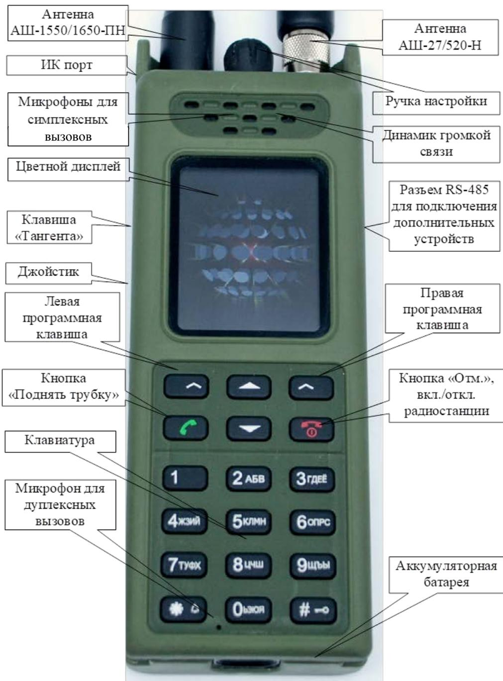
Рис. 2. Внешний вид приемопередатчика производства 2013 г.
