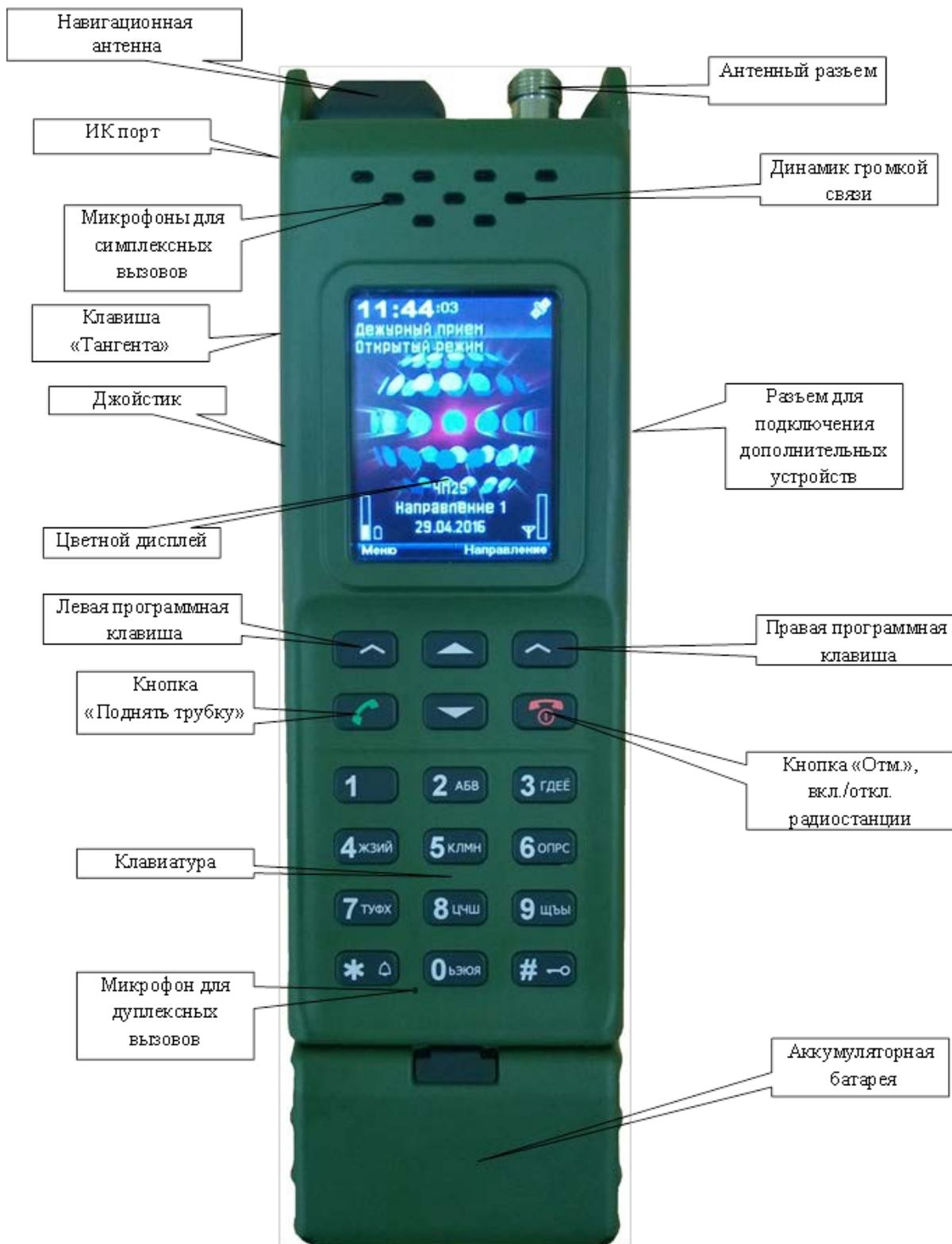
Рис. 3. Внешний вид приемопередатчика производства 2015 г.
