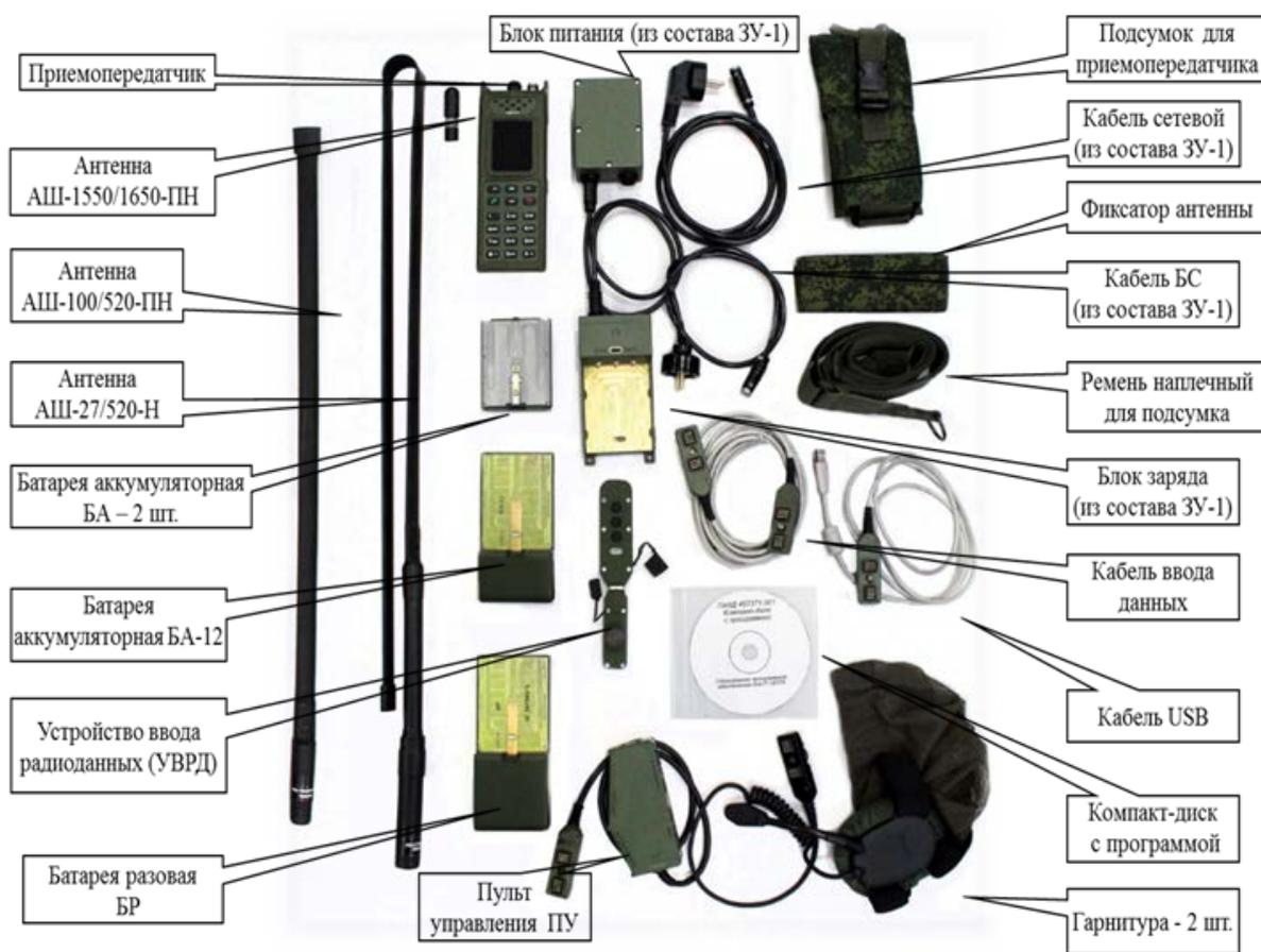
Рис. 1. Рабочий комплект поставки радиостанции производства 2013 г.
