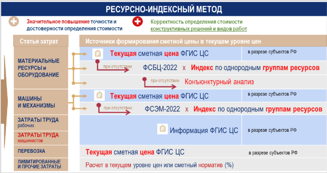
Рис. 1. «Современный» ресурсно-индексный метод определения сметной стоимости
