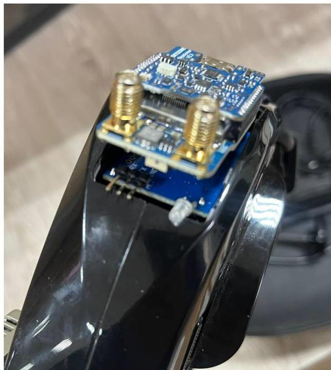
Для использования **Декодера** с другими системами, подключение можно выполнить пайкой либо использованием разъемов типа **PLS** и **PBS**.
