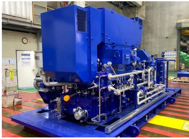
그림 4. 현대중공업터보기계 Air Compressor
