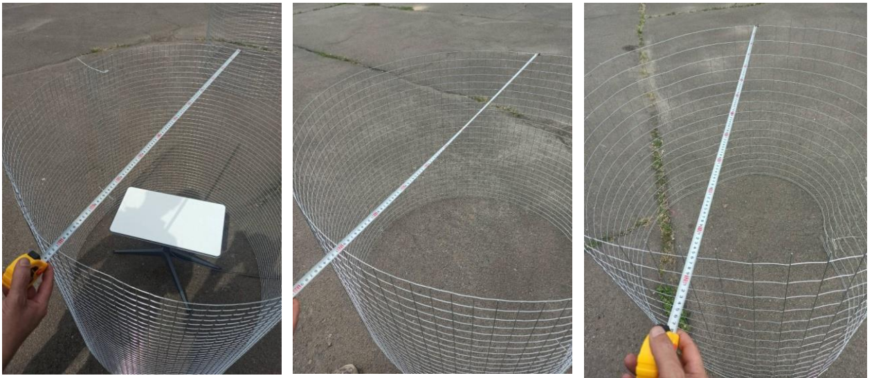
Рисунок 2.13 - Пример «клетки Фарадея» с диаметром окружности от 110 см до 120 см
