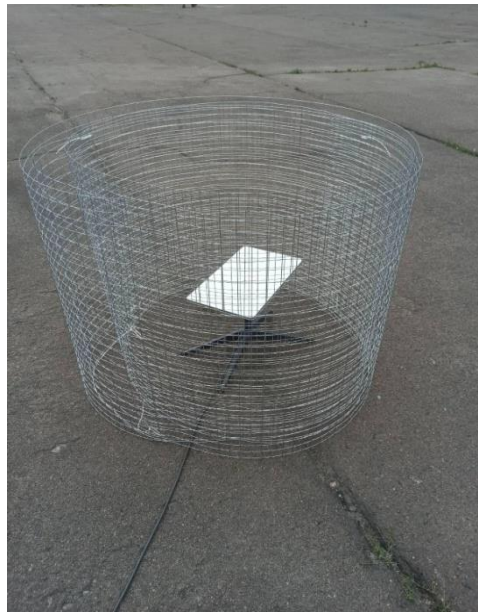
Рисунок 2.15 - Терминал спутниковой связи Starlink защищен "клеткой Фарадея" в три слоя
