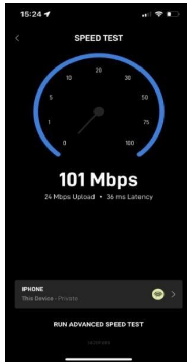
Рисунок 2.16 - Пример показателей скорости передачи данных терминалов спутниковой связи Starlink защищенных «клеткой Фарадея» в три слоя под воздействием средств РЭБ
