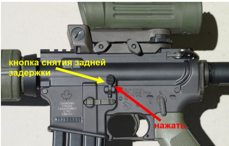
Р и с. 11. Снятие затворной группы с задней задержки
