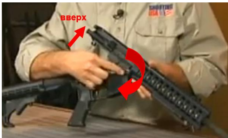
Р и с. 15. Сгибание оружия вокруг оси переднего штифта
