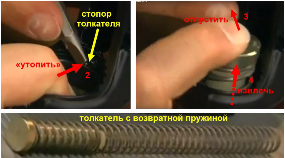
Р и с. 21. Отсоединение толкателя с возвратной пружиной (продолжение)
