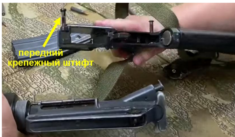
Р и с. 18. Разделение оружия на две основные части
