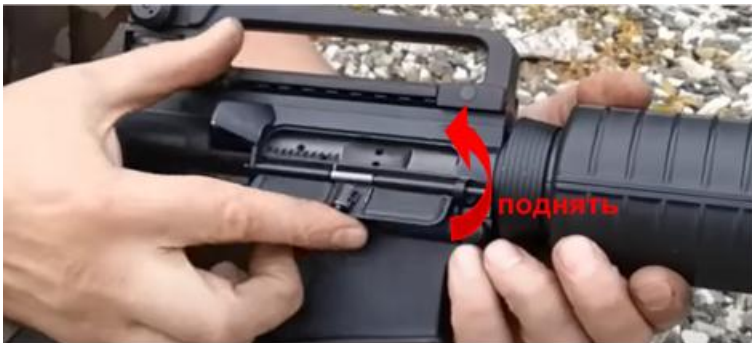
Р и с. 13. Закрывание окна выброса гильз
