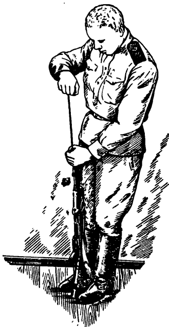
Рис. 8. Чистка ствола автомата без стола
