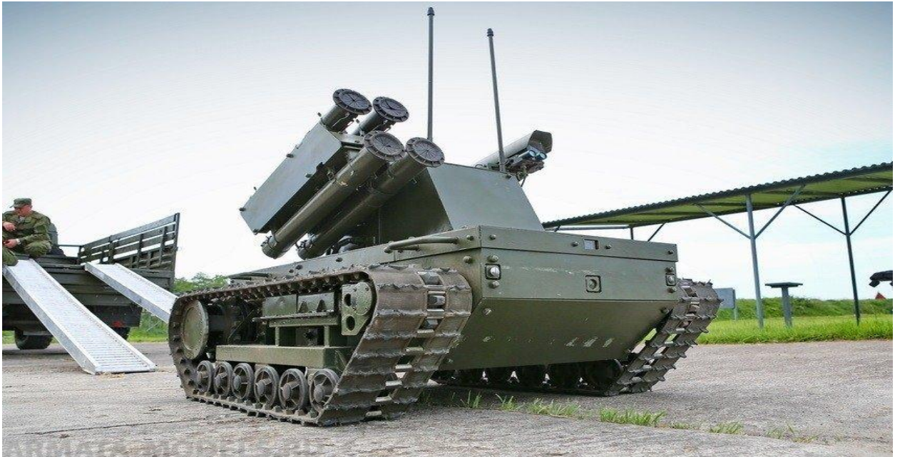
Фото 8. Загальний вигляд роботизованого комплексу Платформа М
