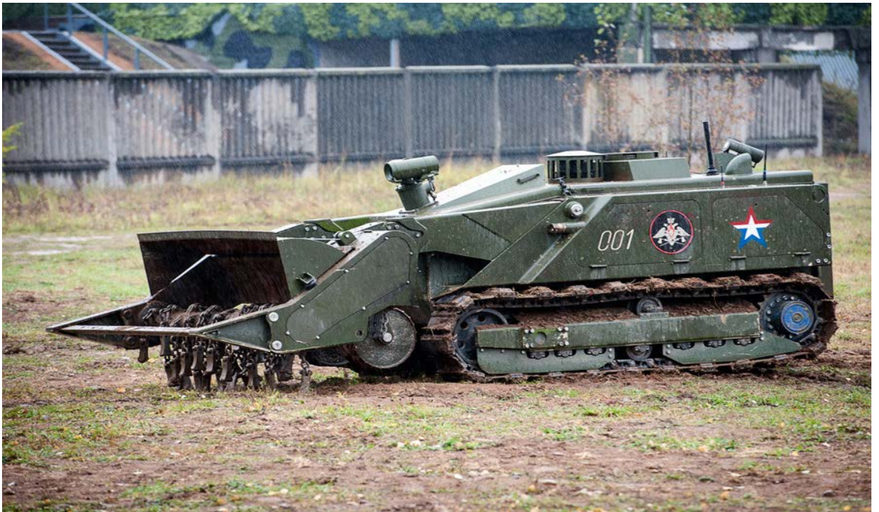
Фото 3. Загальний вигляд роботизованого комплексу УРАН-6
