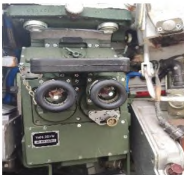
Рисунок 19 – Прибор наблюдения ТКН-3ВУМ
