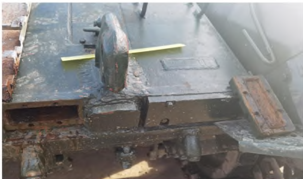
Рисунок 14 – Блок ДЗ, приваренный на верхнюю лобовую деталь корпуса
