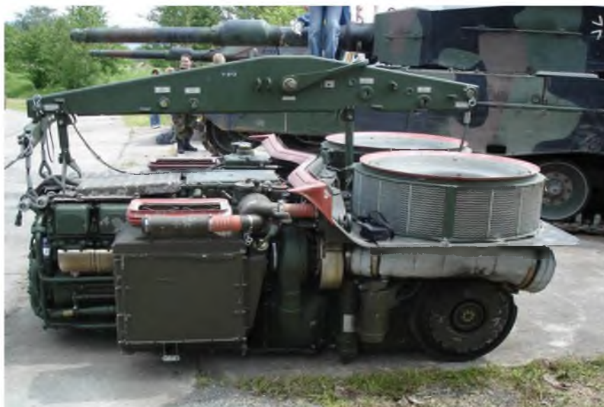
Рисунок 6 – Силовой блок танка Леопард 2А5
