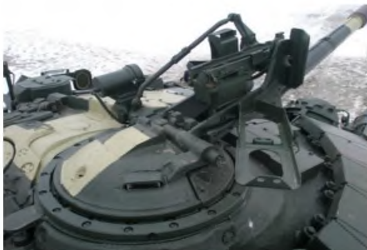
Рисунок 12 – Место установки пулемета НСВТ
