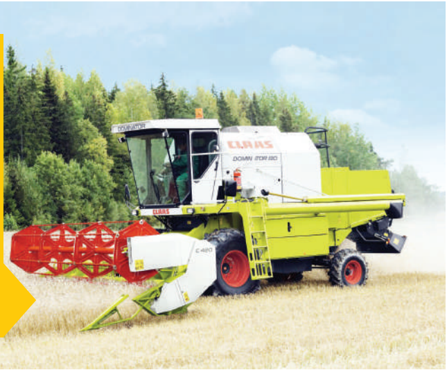
1-расм. “Класс” фирмасининг “Доминатор 130” русумли комбайни
