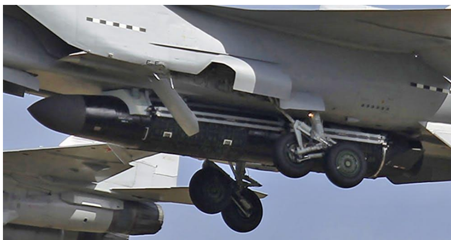
Рис. 2. Масогабаритний макет ракети 14А045 (виріб “293”) / Fig. 2. A full dimension and weight dummy of the 14a045 (product “293”)
