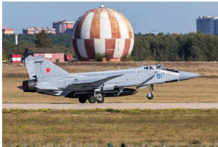
Рис. 1. МіГ-31БМ № 81 із масогабаритним макетом ракети “293” / Fig. 1. MiG-31BM No. 81 with a full dimension and weight dummy of the “293” rocket
