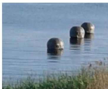
Рис. 16 Имитация металлического моста с использованием пневматического отражателя "СФЕРА-ПР"
