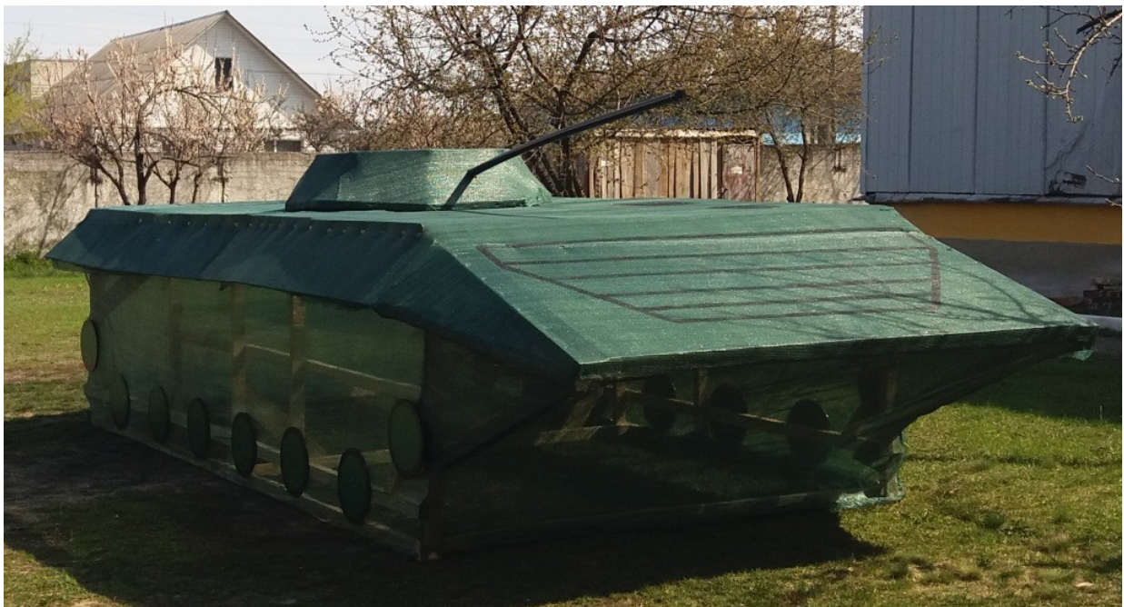
Рис. 21. Макет БМП вне окопа (укрытия) для оптических, радиолокационных и тепловых средств разведки
