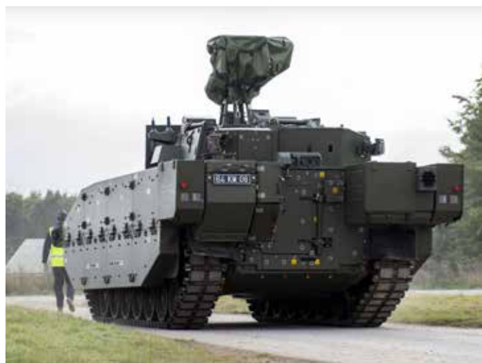
► БМП AJAX, Великобритания. Обращает на себя внимание защита бортов. Фото: upload.wikimedia.org
