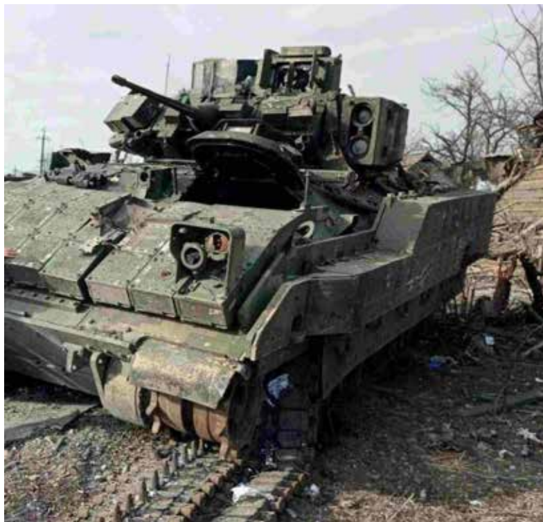
► Подбитая нашими войсками БМП Bradley M2A2 ODS. Видны блоки навесной дополнительной брони и модули динамической защиты BRAT. Один из них сработал. Фото: substackcdn.com
