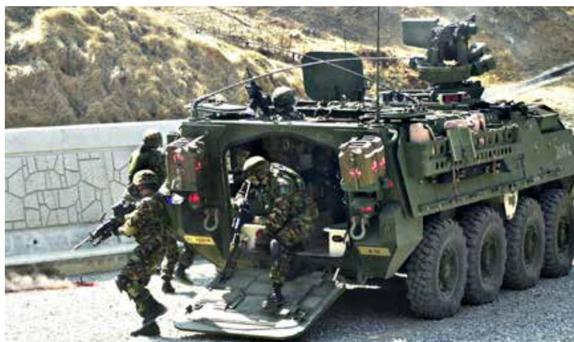
► Высадка американской пехоты из БТР Stryker на учениях. Видно то, насколько широкая и высокая аппарель облегчает выход из машины в бою. Фото: upload.wikimedia.org
