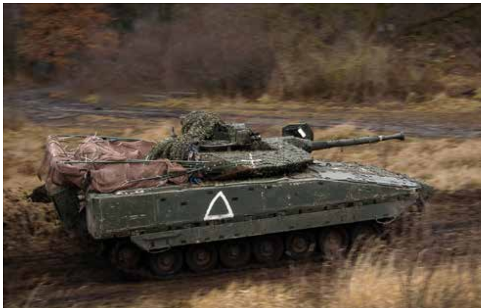
► БМП CV9040C 21-й мехбригады ВСУ. Виден сложенный каркас с сетью для защиты от БЛА типа FPV, машина оснащена 40-мм пушкой Bofors. Фото: upload.wikimedia.org
