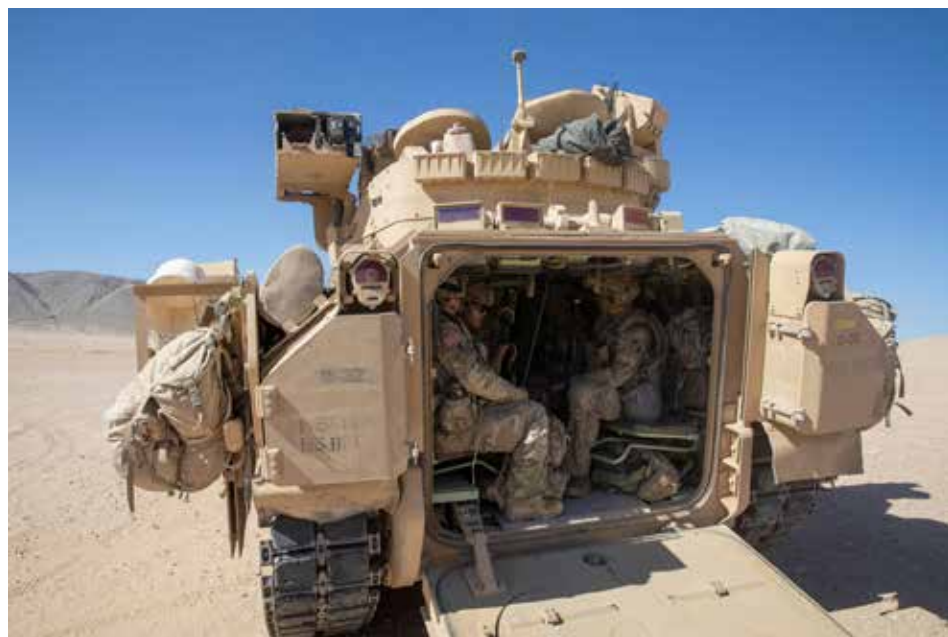
► Размещение личного состава в БМП Bradley. Видно, что высота и ширина десантного отсека позволяют размещать там с относительным комфортом солдат в современном снаряжении. При этом уровень их утомляемости от размещения в течение длительного времени не приводит к утрате ими боеспособности. Фото: sun9-62.userapi.com
