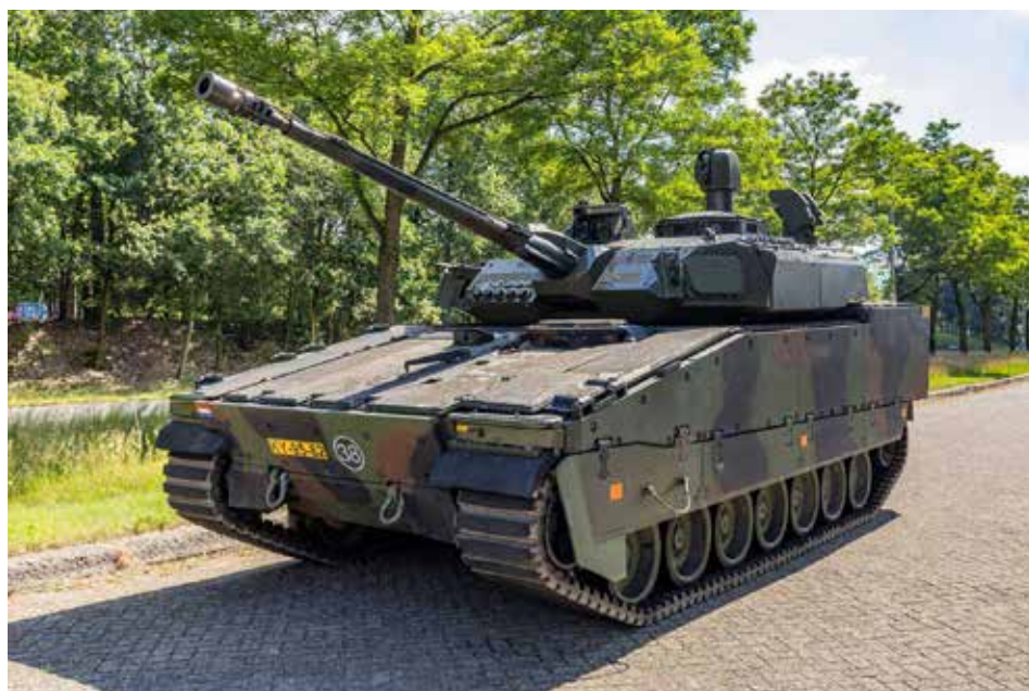
► Новейший вариант БМП CV9035 MkIIIC с 35-мм орудием Bushmaster III. На дульном срезе установлен программатор для снарядов, видно идущий к нему кабель.
