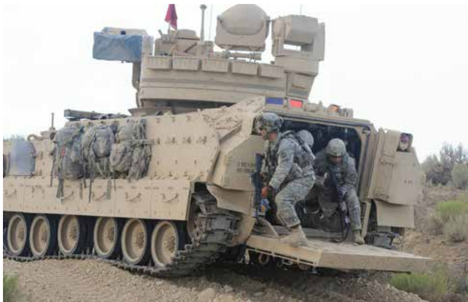
► Высадка американской пехоты из БМП Bradley. Видно то, как на скорость высадки влияют размеры дверного проема в корпусе и аппарат. Фото: img.bemil.chosun.com
