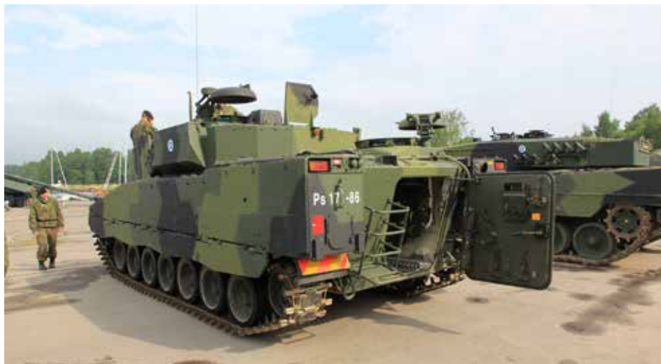
► У БМП CV90 аппарели нет, но размеры двери для посадки-высадки достаточно велики, чтобы сделать ее беспроблемной. Объем десантного отсека тоже вполне достаточен.
