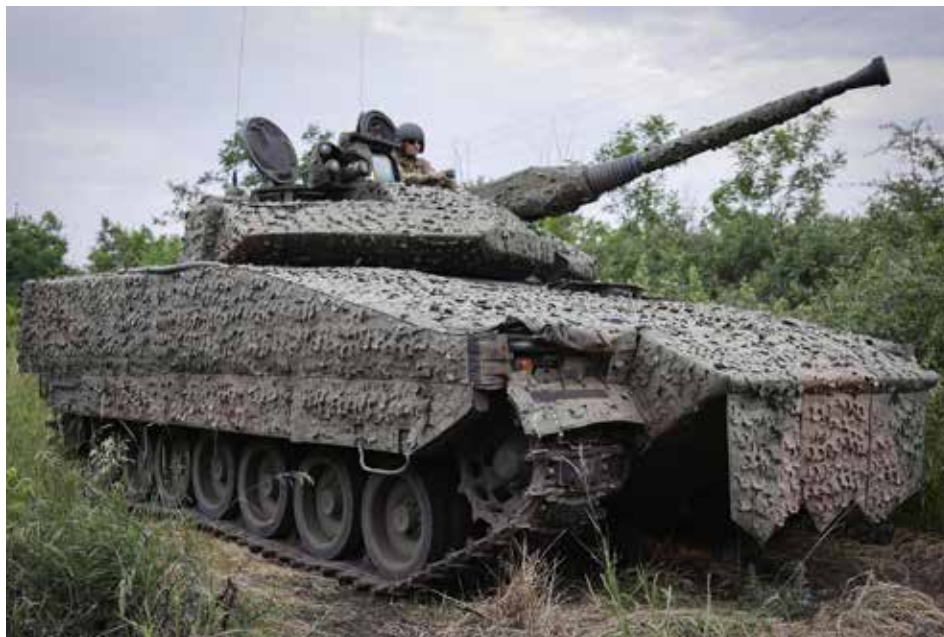
► Пушка Bofors калибром 40 мм на одной из БМП CV90. Рост калибра орудий на БМП – объективная реальность, игнорировать которую уже невозможно. Фото: dynaimage.cdn.cnn.com
