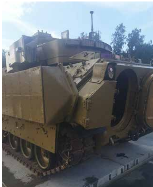
► Дверца в аппарели БМП Bradley, захваченной у противника. Видно количество и толщина дополнительных бронедеталей, а также модули динамической защиты BRAT. Фото автора
