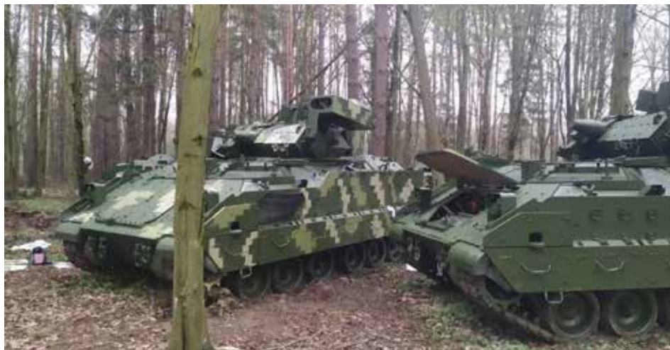
► БМП M2A2 ODS Bradley BCU, в украинском «пиксельном» камуфляже. Хорошо видны накладные бронеплиты. Фото: media.defenseromania.ro
