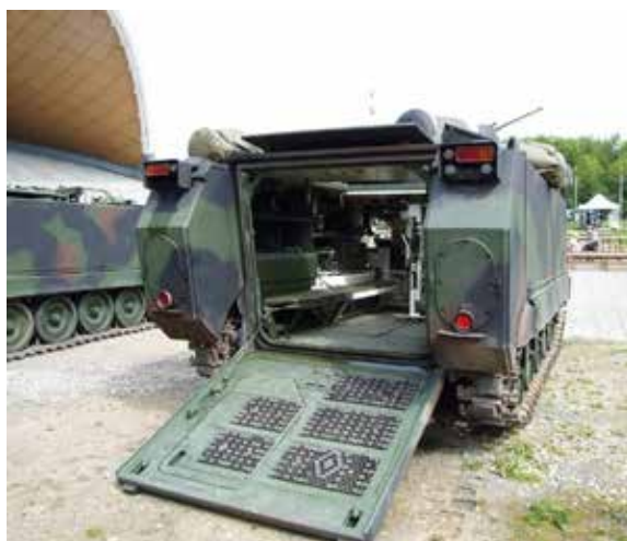
► Кормовая аппарель БТР М113, видна дверь в аппарели, ширина аппарели позволяет высаживать солдат в два потока и в современном снаряжении. Фото: file.gosniipp.ru
