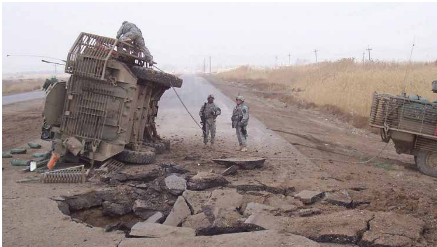
► Деревня Шейх-Хамед, Ирак, 15 апреля 2007. М 1126 Страйкер 3-й бригады 2-й пехотной дивизии после подрыва заглубленного самодельного взрывного устройства. Несмотря на мощный взрыв, перевернувший бронемашину, потерь в личном составе не было, разрушений корпуса БТР тоже. Позднее бронетранспортер был восстановлен. Обращают на себя внимание противокумулятивные решетки. Фото: upload.wikimedia.org
