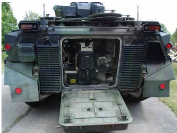
► Кормовая аппарель для пехоты в БМП Marder 1A3, видна ширина аппарели и высота транспортного отсека. Фото: upload.wikimedia.org
