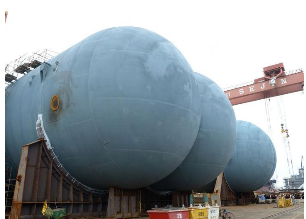
그림 133. 세진중공업의 Bilobe Type LCO2 탱크
