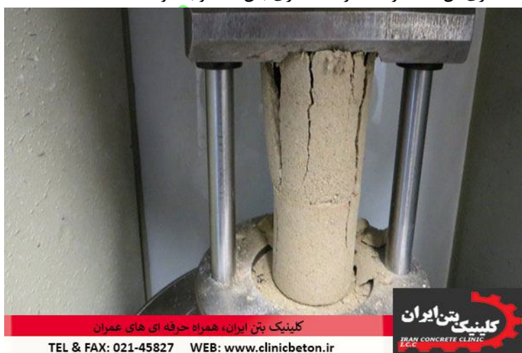
شکل ۷-۸- آزمایش مقاومت فشاری بتن
