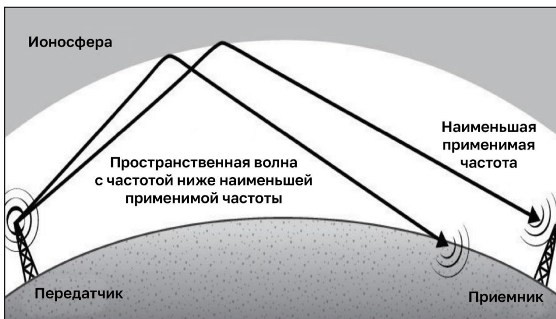
Рис. А-19. Рефракция волны с частотой ниже наименьшей применимой частоты
