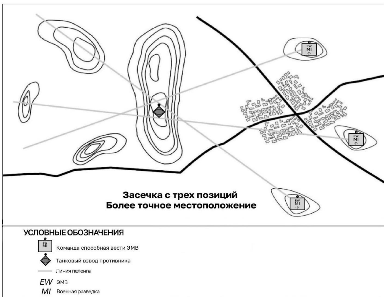
Рис 6-3. Засечка с трех позиций ( fix )
