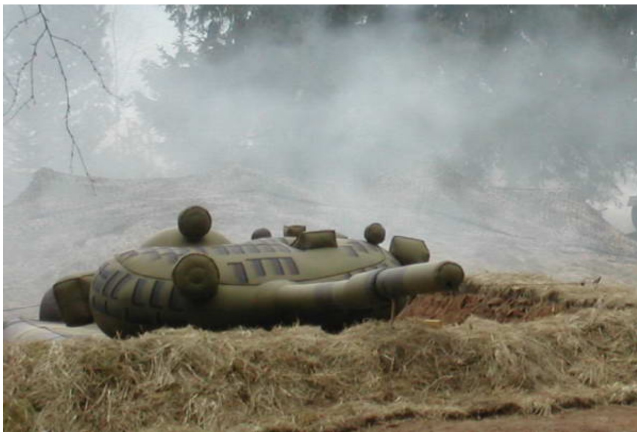
Макет танка в укрытии (работают имитаторы дымов).
