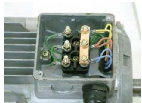
- اتصال ستاره سیم پیچ های موتور
