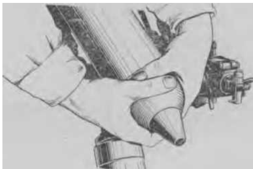
Рисунок 3.1 – Вилучення міни з каналу ствола
