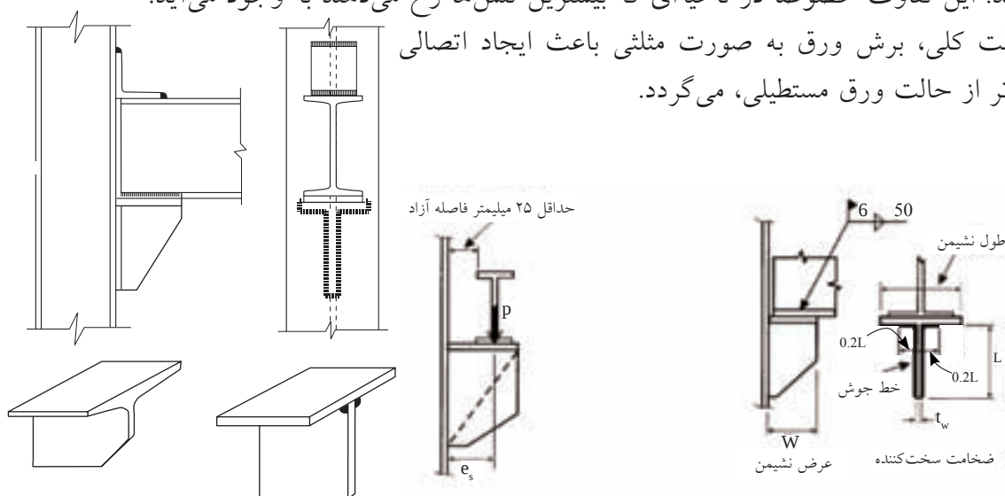
شکل ۸-۴- انواع اتصال ساده با نشیمن تقویت شده
