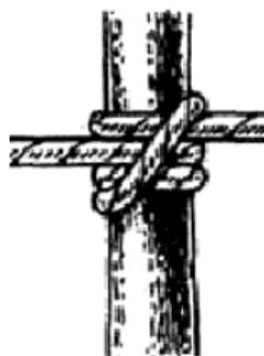
С дополнительным оборотом используется, например, для регулировки длины верёвки, захлестнутой за колышек (taut-line hitch, midshipman's hitch, tent hitch):
