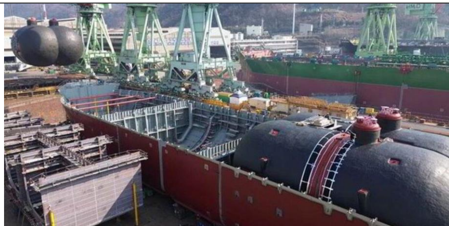
그림 2. 22K-CBM LCO2c의 Bilobe Type 탱크 도크 탑재 모습: 2개의 탱크가 탑재되어 LPG, 암모니아, LCO2 중 2개의 화물을 동시에 운송 가능.
