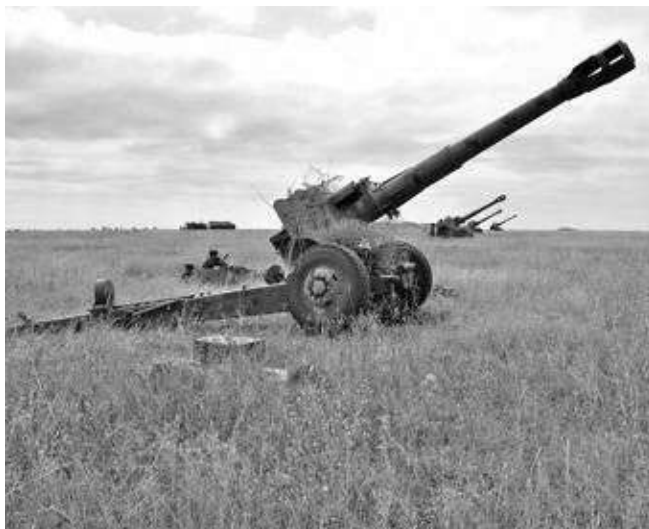
Гаубица Д-20 калибра 152 мм. Это почти музейное орудие успешно использовалось, в частности, в боях за Донбасс летом 2022 года
