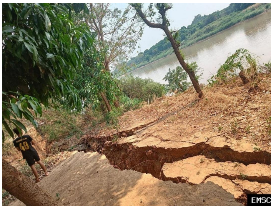
شکل ۲۹- عکسی از شکاف‌های مرتبط با روانگرایی در Pyay، میانمار. منبع: EMSC.
