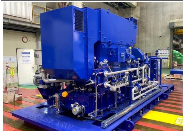
그림 50. 현대중공업터보기계 Air Compressor
