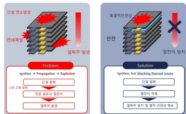
그림 62. 세스멧 단열패드 작동 원리
