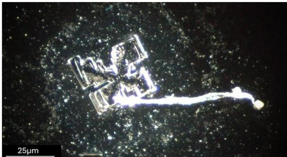
Figura 28. Un "assemblaggio cristallo-fibra". Ingrandimento 100x.
