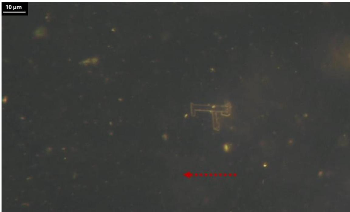
Figura 9 Struttura dinamica autoassemblata osservata all'interno della fase liquida, che mostra un movimento indicativo della redistribuzione del materiale attivo. La freccia rossa tratteggiata evidenzia la direzione del flusso del liquido, sottolineando le interazioni dinamiche che guidano l'autoassemblaggio. Ingrandimento 200x.
