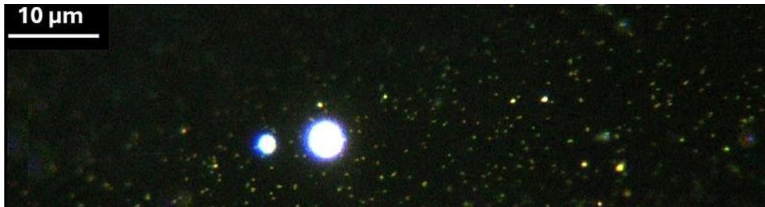
La Figura 141 mostra colloidali dispersi e contaminanti riflettenti più grandi. I colloidali appaiono come punti sottili e luminosi, mentre i riflessi più grandi e intensi indicano impurità minerali o particellari. Ingrandimento 100x.
