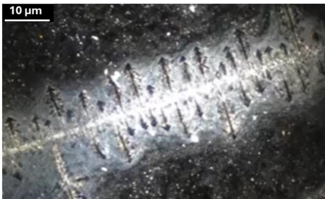
Figura 30. Vista ravvicinata dei cristalli aghiformi, che mette in risalto le punte nere ai termini di ramificazione. Questo dettaglio rivela la dinamica localizzata dei soluti e le variazioni di materiale all'interno dell'ambiente di cristallizzazione manipolato. Ingrandimento 200x.
