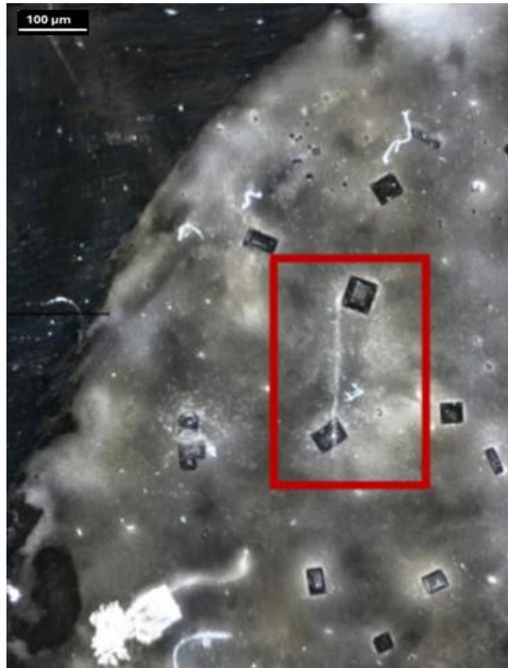
Figura 102. Immagine a basso ingrandimento del bordo della goccia dopo due mesi, che evidenzia la transizione delle strutture cristalline da formazioni iniziali morbide ad architetture più grandi e organizzate. La regione contrassegnata indica la posizione di un "assemblaggio cristallo-fibra" (CFA), come illustrato nella Figura 92, offrendo un riferimento per ipotizzare meccanismi di organizzazione strutturale all'interno della matrice. Ingrandimento 25x.
