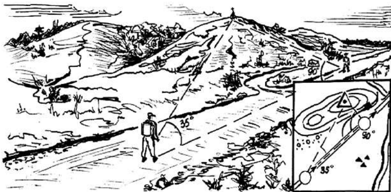
Рис. 122. Определение точки стояния засечкой по боковому ориентиру
