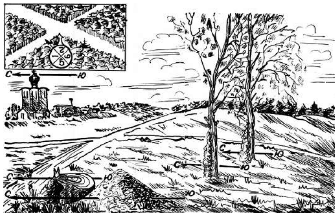
Рис. 112. Определение сторон горизонта по признакам местных предметов
