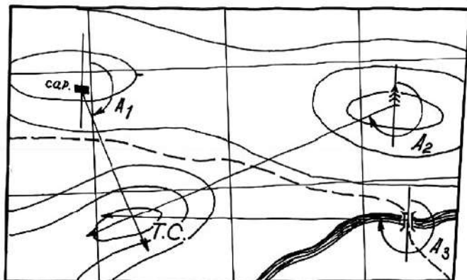
Рис. 124. Определение точки стояния засечкой по обратным дирекционным углам
