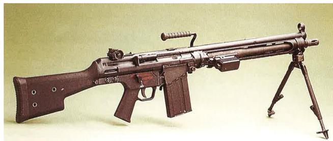
**HK 13(HK 33L):** Вариант HK 33 в формфакторе лёгкого пулемёта, с более тяжёлым стволом сошками, использовал широкую номенклатуру магазинов вплоть до барабана на 100 патронов.
