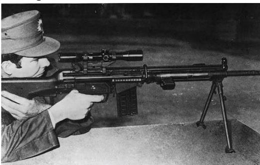
установленным более точным «отобранном» стволом и наличием оптического прицела на стандартном кронштейне. Штатно применялся 20-зарядный магазин от винтовки НК G3 или с 50-патронный барабанного типа от пулемета НК 11. Кроме того, винтовка сохраняла унаследованную от ручного пулемета возможность замены приемника магазинов на приемник ленты от пулемета НК 21E.
