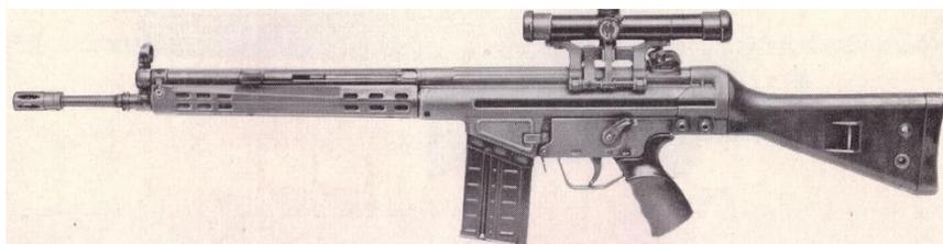
Винтовка НК G3A3 с установленным оптическим прицелом
