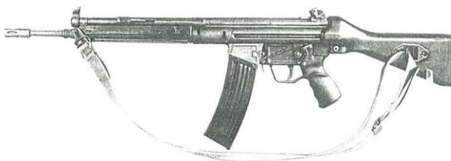
**HK 13E(E1):** Аналог HK11E, но под патрон 5.56x45mm, имеет возможность установить лентоприёмник.
