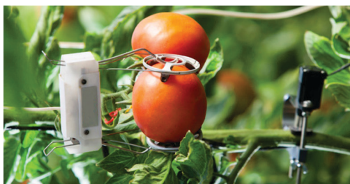
Рис. 1.1. Датчик контроля роста томата передает данные беспроводным способом на пульт контроля
