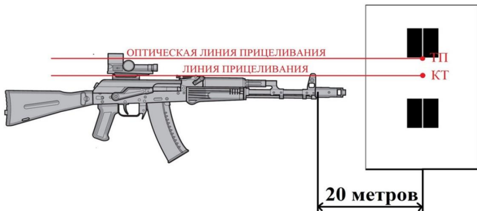
Рисунок 9 – Схема определения контрольной точки при проверке боя АК74 и его модификаций с различными оптическими и оптико электронными прицелами
