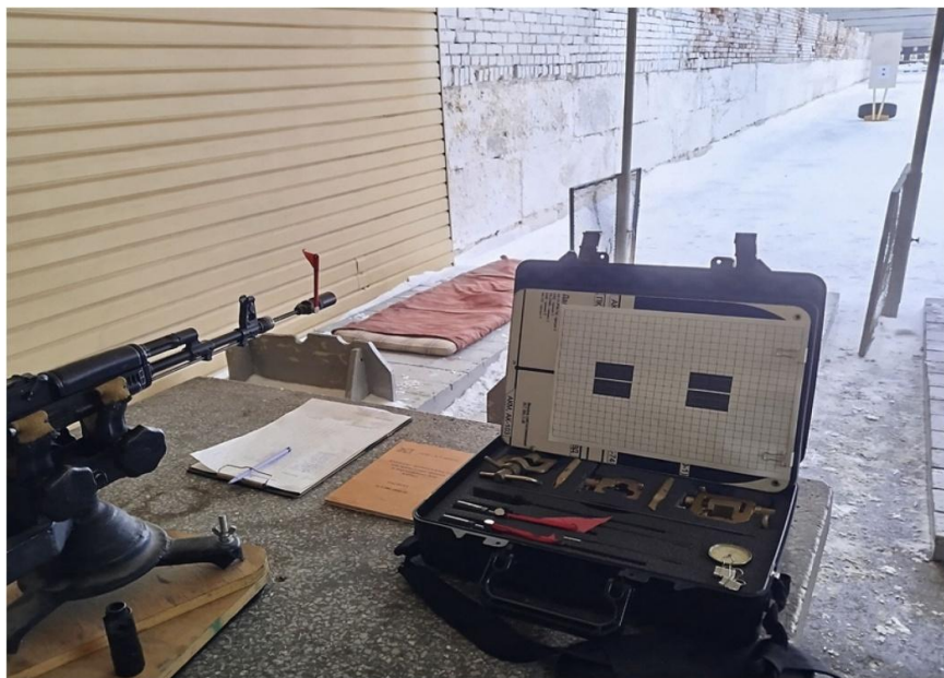
Рисунок 12 – Проверка боя АК74 при помощи комплекта принадлежностей для приведения оружия к нормальному бою (КППО)
