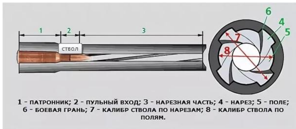
Рисунок 2. Элементы и составные части ствола оружия
