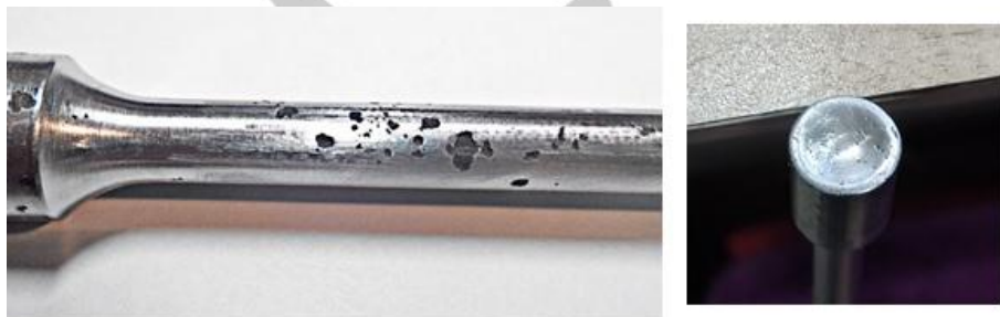
Рисунок 8. Коррозия на газовом поршне и зеркале поршня
