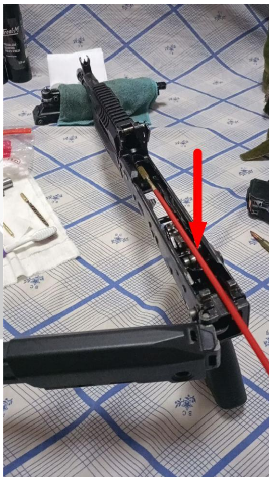
Рисунок 38. Процесс заведения шомпола с ершом в канал ствола
