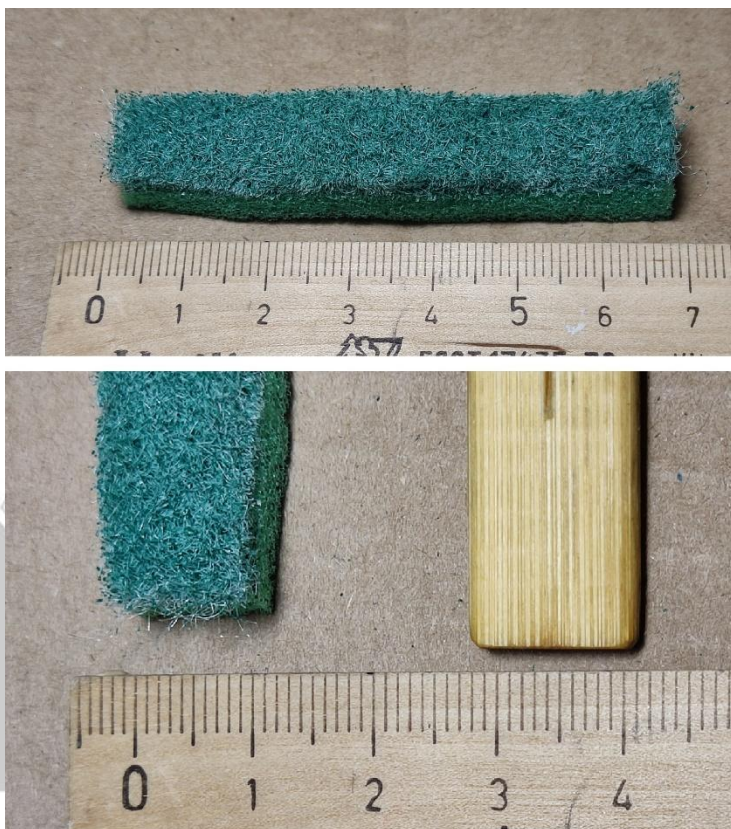
Рисунок 33. Подготовка абразивной губки и палочки для чистки газовой камеры (патрубка камеры)
