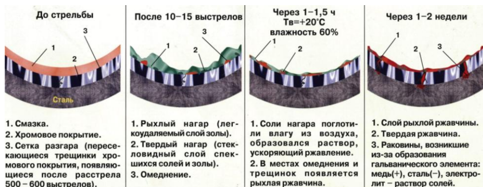
Рисунок 1. Процесс коррозии внутренней поверхности ствола
