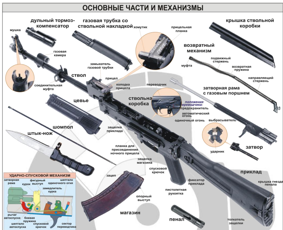
Рисунок 3. Схема частей и механизмов АК74(М) (приведена для наглядности)
