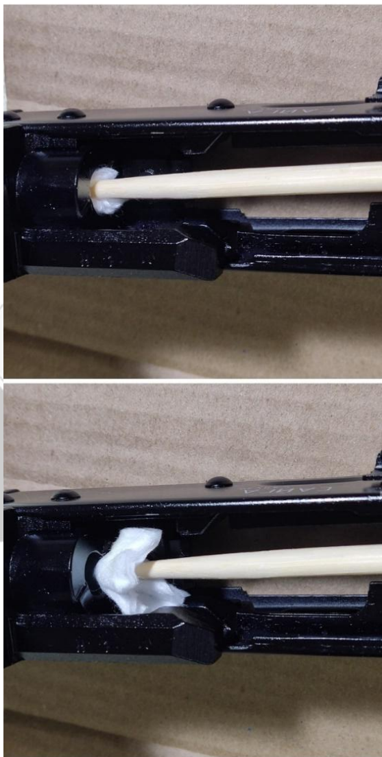
Рисунок 32. Чистка патронника четвертинкой ватного диска
