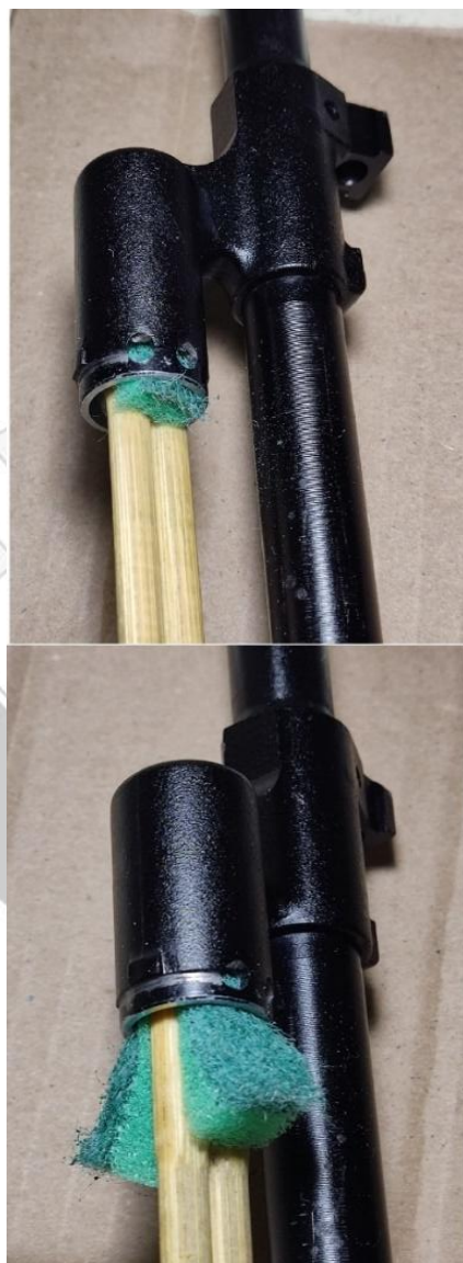
Рисунок 34. Процесс чистки газовой камеры (патрубка камеры)
