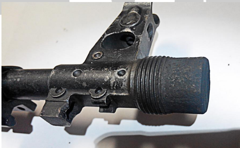
Рисунок 10. Результат отсутствия чистки при большом настреле
