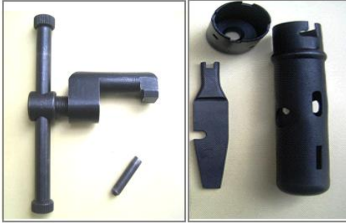
شکل های ۱-۲ آچار تنظیم بردوسمت در کلاشینکف
