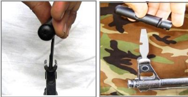
شکل های ۱-۳ طریقه قرار گرفتن آچار در برد روی مگسک
