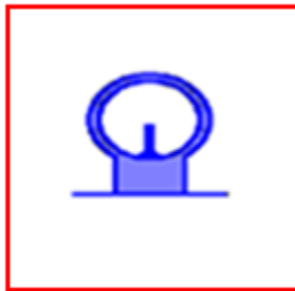
شکل ۶- ۴ تشکیل خط نشانه روی سلاح ژ۳
