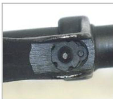
شکل های ۵- ۱- مگسک وگردونه تنظیم درست اسلحه سی کیو
