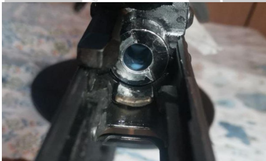
Рисунок 5. В патроннике виден сольвент с растворенной медью – голубоватая лужица.
