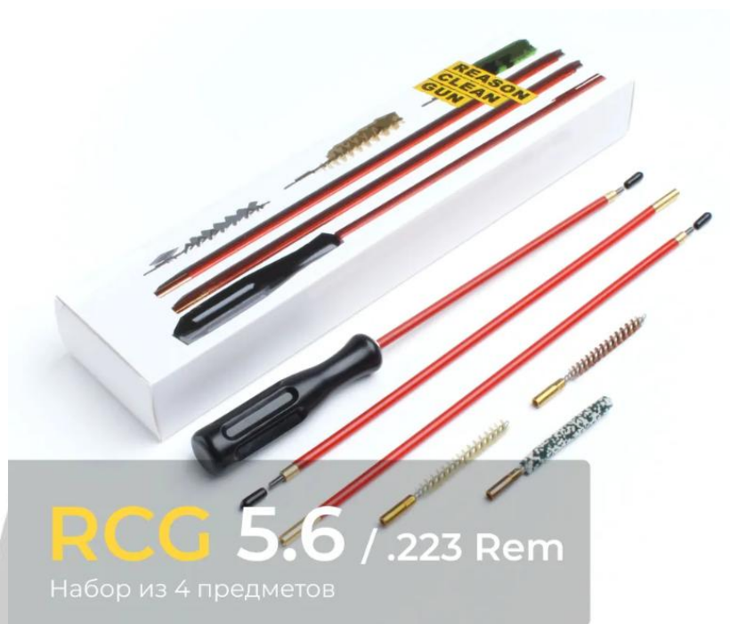
Рисунок 49. Набор из сборного шомпола и ершей для калибра 5,6 мм/.223Rem (диаметр шомпола 5 мм(!), присоединительная резьба для ершей «папа-5/40»)
