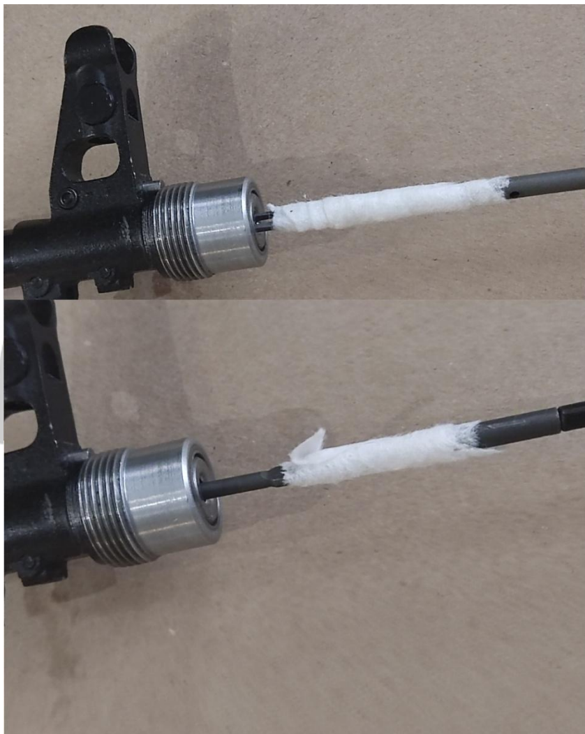
Рисунок 31. «...Ввести шомпол с протиркой и паклей, в канал ствола...»
