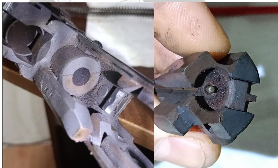
Рисунок 11. Фото деталей АК-12. На фото виден нагар и лак, который «состругивается» с гильз при подаче патрона в патронник (с) Буля
