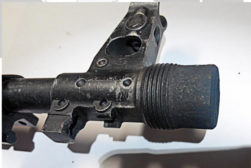
Рисунок 10. Результат отсутствия чистки при большом настреле
