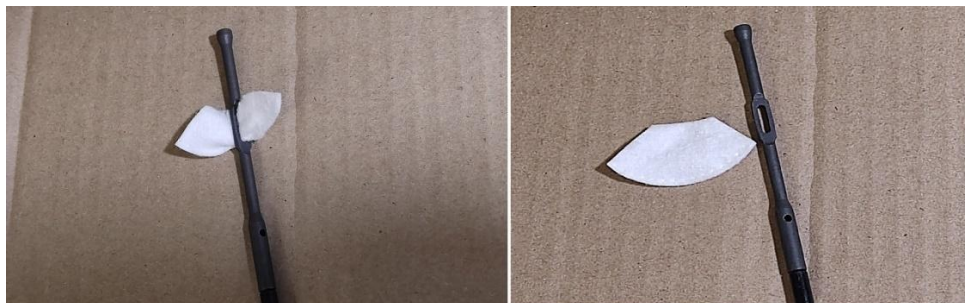
Рисунок 25. Патч из ватного диска (ветошь) совместимый с любой протиркой 5,45-мм автомата (пулемета)
