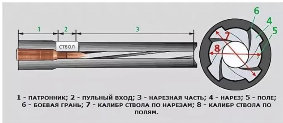
Рисунок 2. Элементы и составные части ствола оружия
