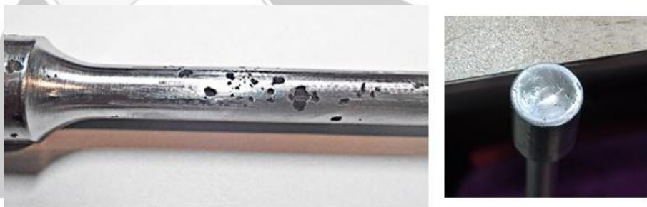
Рисунок 8. Коррозия на газовом поршне и зеркале поршня
