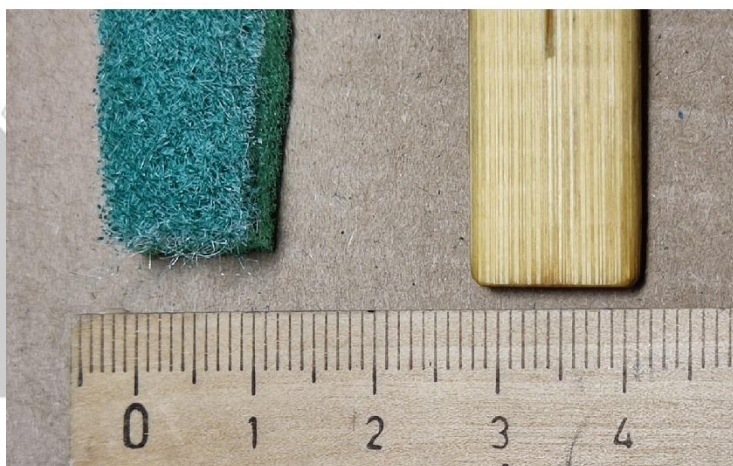
Рисунок 33. Подготовка абразивной губки и палочки для чистки газовой камеры (патрубка камеры)
