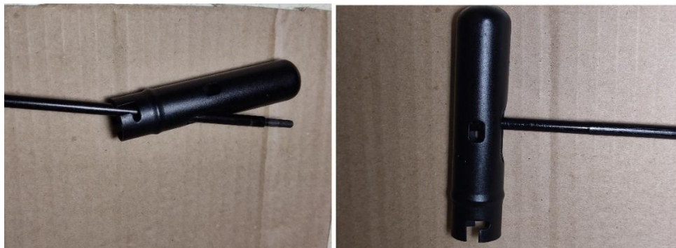
Рисунок 28. Подготовка шомпола к чистке – установка рукоятки из пенала
