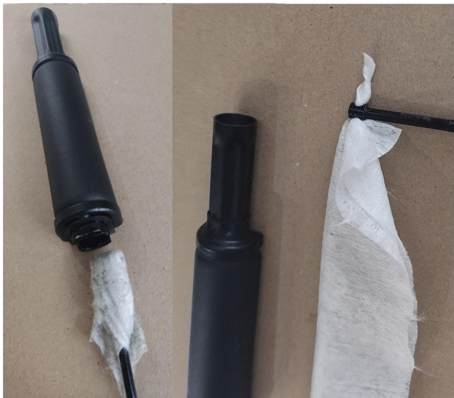
Рисунок 35. Проденьте уголок ветоши через отверстие в набалдашнике шомпола и накрутите ветошь так, чтобы получился протирачный патч нужного диаметра
