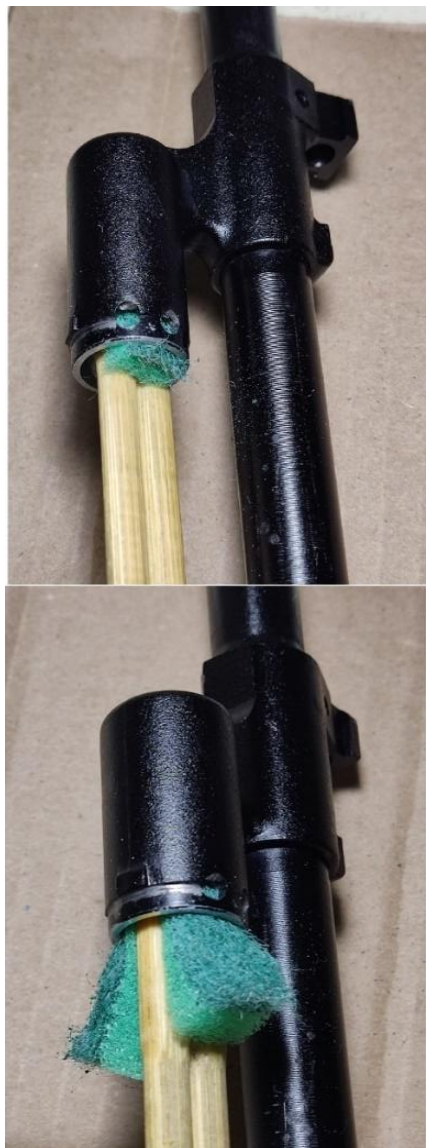
Рисунок 34. Процесс чистки газовой камеры (патрубка камеры)
