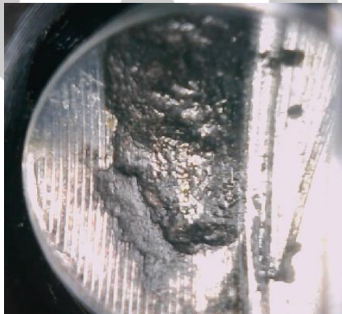
Рисунок 7. Коррозия и отвердевший нагар на стенке патрубка газовой камеры
