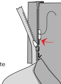
Pliez la parementure droite de la braguette sur la ligne milieu devant vers l'intérieur. Piquez la bordure droite de la braguette près du bord. Positionnez la bordure droite de la braguette sur l'empiecement braguette, contre la ligne milieu devant de la bordure gauche de la braguette et surfilez.
