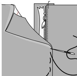
Piquez la 2<sup>e</sup> partie de la fermeture éclair 2 cm à partir de milieu devant sur la parementure droite de la braguette.
