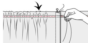
Placez les épingles en travers. Épinglez la bordure lisse et la bordure froncée. Réglez la machine à coudre sur une position normale. Piquez entre les fils de fronces en retirant les épingles. Puis enlevez les fils de fronces.
